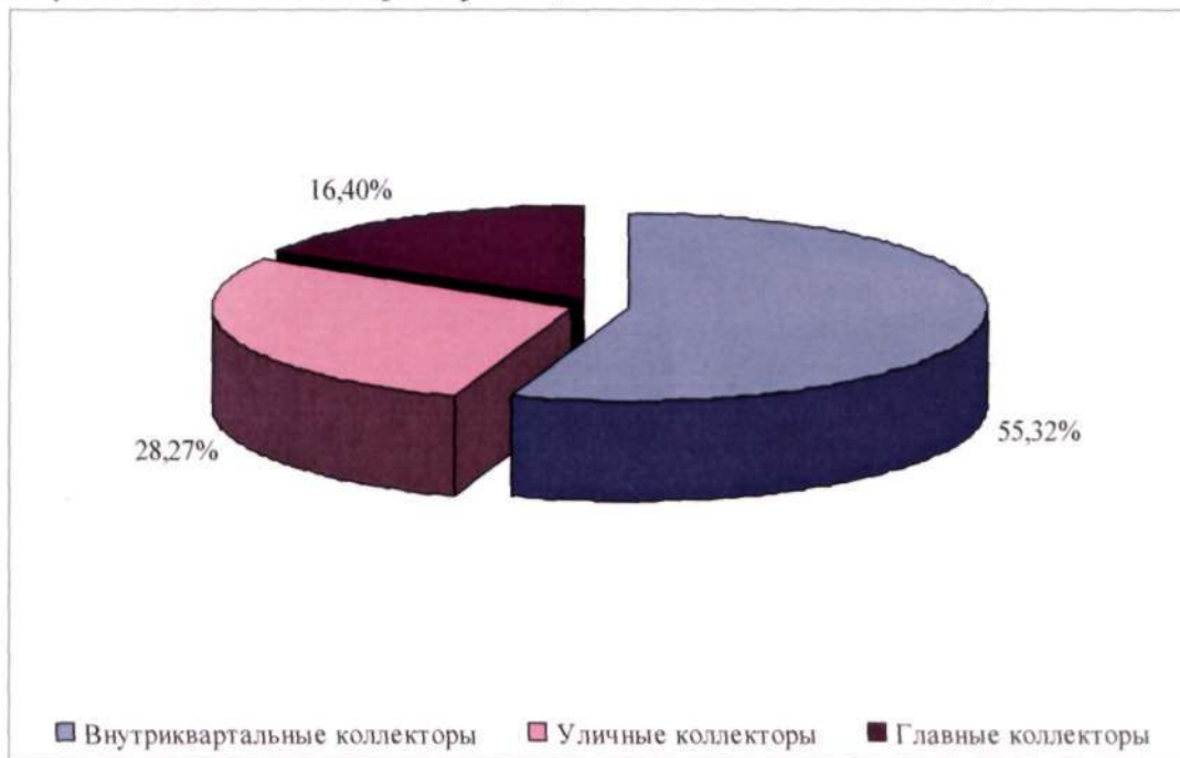
Рисунок 3 Виды коллекторов производственно-бытовой канализации
